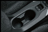
EBP y Hold: En la versión híbrida cuenta con freno de estacionamiento electrónico (EBP) y sistema de retención de frenos (Hold).
